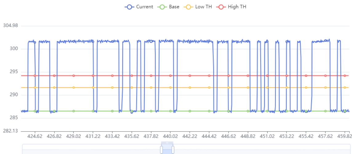
Powiększony wycinek odpowiedzi licznika. Prąd jałowy magistrali 287 mA (ok. 200 liczników).
